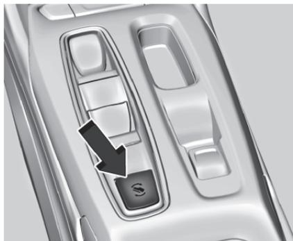
원-페달 주행을 사용하려면, 전기 구동 시스템 변속 버튼 조절장치에서 원-페달 버튼을 누릅니다. 지시등은 계기판에서 표시됩니다. 이 기능은, 활성화된 경우, D(주행) 및 R(후진) 위치 모두에서 적용됩니다. 이 기능은 운전자가 수동으로 비활성화할때까지 활성화 상태로 유지됩니다.
