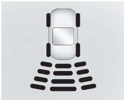
계기판에는 ‘장애물과의 거리’를 보여 주는 바가 있으며 주차 보조장치 시스템을 위한 장애물 위치 정보를 보여주는 주차 보조 디스플레이가 있을 수 있습니다. 장애물이 가까워지면 바가 더 많이 빛나며 노란색, 주황색, 적색 순으로 변경될 수 있습니다.
