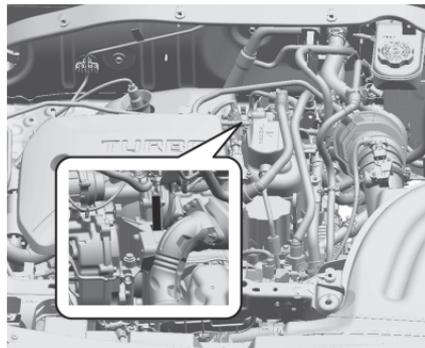
엔진 형식 및 번호는 은 차량 앞쪽에서 엔진룸을 바라볼 때, 실린더 블록 우측 후면부에 타각되어 있습니다.
