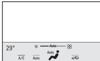
센터 스택의 온도 조절 시스템 조절 장치를 조작 할 경우 인포테인먼트 디스플레이에 온도 조절 시스템 상태가 잠시 표시됩니다.
